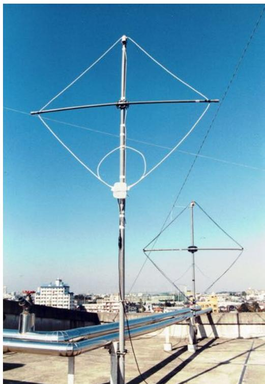
遠隔同調型短波帯小型ループアンテナ(短小)。奥下側に遠隔同調型中波帯小型ループアンテナ(中小)がある
