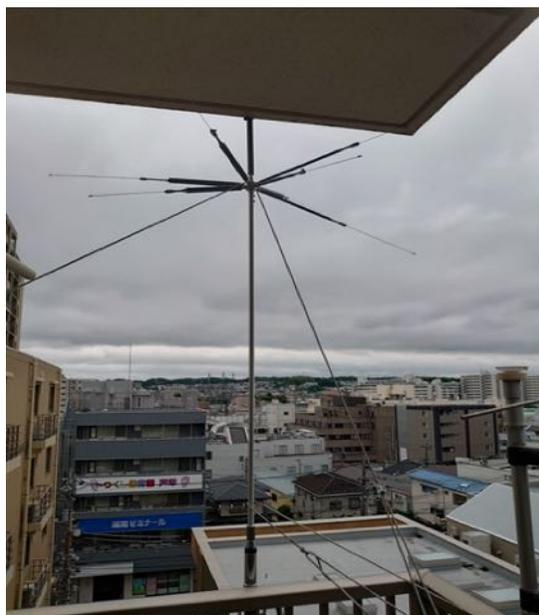
て調整していましたが、UHV-10ではエレメント調整がネジで出来るように改善されているので、調整し易いです。UHV-10の台座の所に今まで使用していた5m x 5本のカウンターポイズ用ビニール線を繋ぎ、さらに2.7m x 2本 + 2.5m 1本のビニール線を追加しました(台座から床までは1.20m)。ベランダの床にアルミテープ(幅5cm)で張っていきます。
