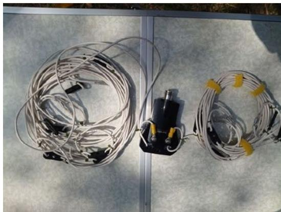
OM 指導の元、K 本氏にも手伝って頂き、O 川 OM 特製「ギボシ・アンテナ」の制作を敢行する。ポールには6mとも網を使用し、公園の階段上のフェンスにマジックテープで固定する。「ギボシ・アンテナ」とは逆 V 字型のダイポールアンテナであり6mポールの先端部にバランを付けて、逆 V 字にビニール線を張る。そのビニール線の途中途中にバンド調整用のギボシ端子(オスメス)を付ける。
