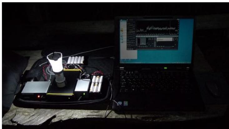
ノート PC ケースに SDR 機材を収納した”Shack-in-a-Box”
