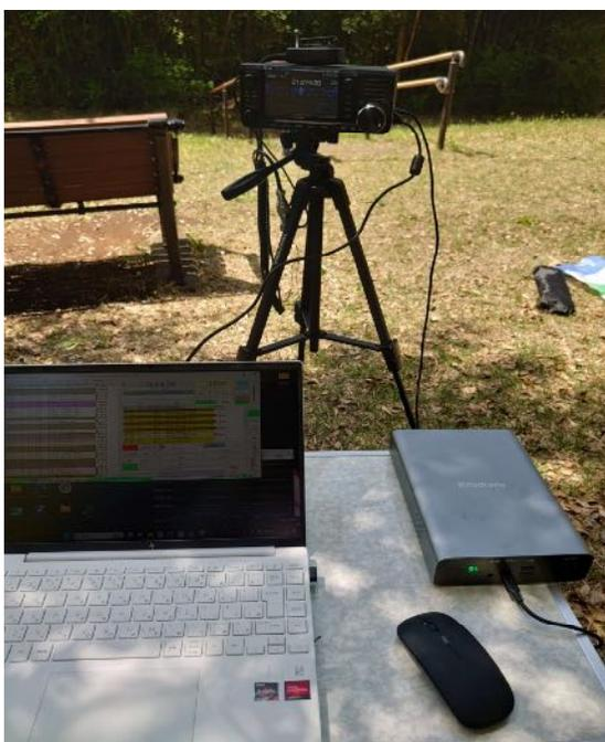
が不要であり、快適です。リグは IC-705 を使用し、12V 出力外部バッテリー + DCDCUP コンバーター(秋月のキット)で 13.8V の電源供給するので、送信出力は 10W です。ただ、18MHz で運用始め
