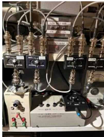
プリアンプの挿入、バイパスを切り替える TV 用同軸スイッチ 4 台と、接続の為の同軸ケーブル数本を購入しました。(6000 円)これでアンテナのゲインをきめ細かく選べるようにな
