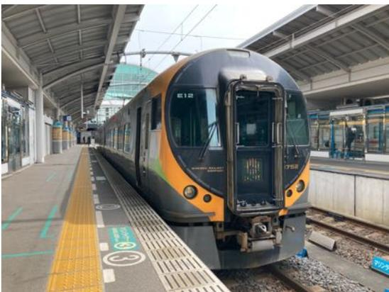
JRの特急いしづち 8600系。空気ばね式車体傾斜方式で、カーブの多い予讃線も爆走していく
