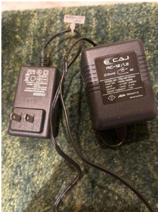
(左側がスイッチング電源 右側がトランス式 AC アダプタ)
