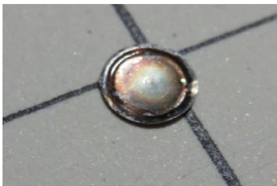
凸型金属板の裏からポンチなどで優しく叩きだす
