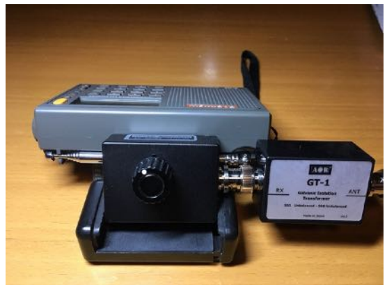
ApexRadio 55CPL-AT は100均ショップのスマホホルダー（カメラ三脚穴付き）に挟むとちょうど角度も出せて、R-108 のバーアンテナ面に近く接続出来ます
