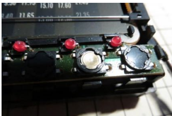
押されて凹んだまま戻らない凸型金属板
