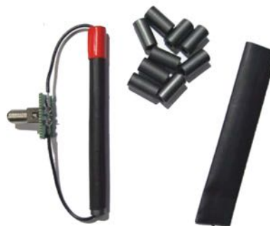
フェライトビーズを連結して作成された電流トランス
