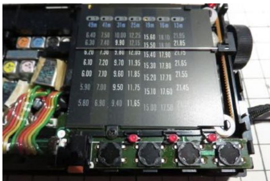
スイッチ前面の黒いブラシートの裏に凸型金属板がある
