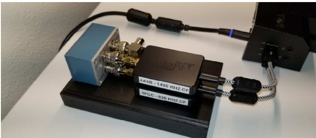
Mini-Circuits のスプリッター (ZSC-3-1)を使用した Guy Atkins 氏の芸術的なセッティング
