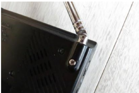
根元の膨らんだ部分にひびが入ることが多い
