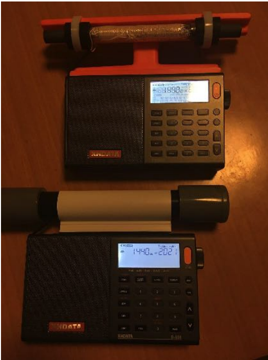
上: 7.5" AMIDON Type61 Loopstick Gary DeBok-san version Assembled in Japan! 下: 200 mm R40C1 Loop Stick を装着した D-808
