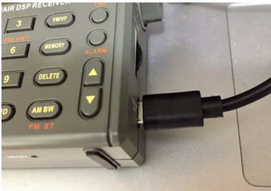
USB 電源ジャックは、プラグが途中までしか挿さらない。
