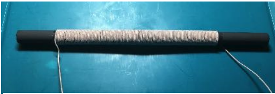
R40C1 にリッツ線 250/46 を巻き上げてみる。この後さらに巻き足した
