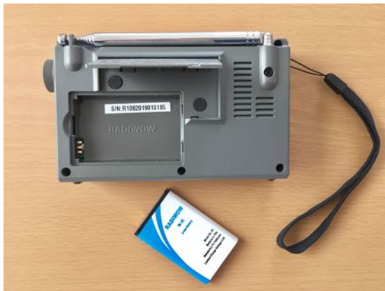
R-108 背面。スタンドを持ち上げてから電池ボックスにアクセスする、なんともトリッキーな構造。
