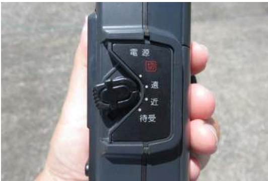
電源スイッチは右側 遠距離通信、近距離通信を選べる
