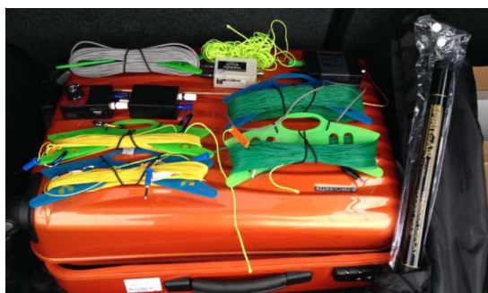
右中: 緑色のワイヤーはBOG用。1束が100m。 左中: 黄色のワイヤーはTDDF用。2束で1セット。その上にマッチングボックス他 右: ミニポールとステーキセット
