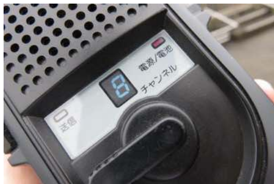
ダイヤルを回すとチャンネルが変わる
