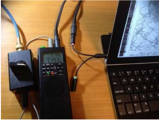
左: 外部アンテナからアッテネータ付き取り込み 中: GP5/SSB (注) 機材トップ中央にアンテナ入力しているが ラジオの取説的にはホイップアンテナへ接続させる。アンテナは屋外に設置の K9AY ワイヤー。 右: iPadに HF-FAX アプリで受信中の様子
