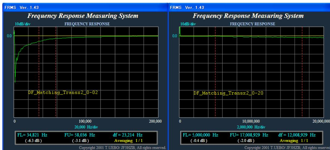
図6 MTの周波数特性(左:0~200kHz、右:0~20MHz)
