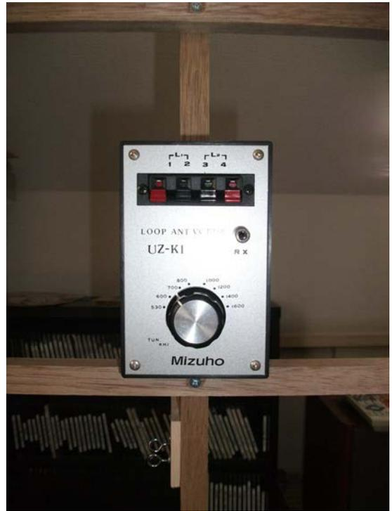
さて実戦での使用感だが、一辺 1m×6 回巻きのエレメントから得られるゲインはかなりのものがある。自宅のベランダに設置して ICF-2010 に接続して使用すると、単体では弱々しい 630/KUAM が浮かび上がってくる。また指向性の切れ味も鋭く、アンテナの回転に応じてこれまた信号が浮かび上がったり沈んだりする。エレメントが長かったのか中波帯の下限（500 kHz 帯）には同調していなかったので、若干の調整が必要のようである。
