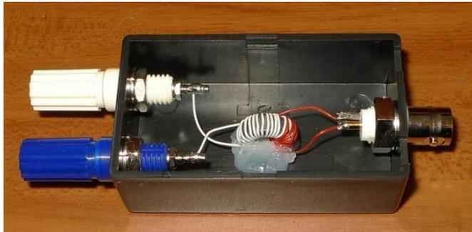
図3 マッチング・トランス MT の外観と内部
